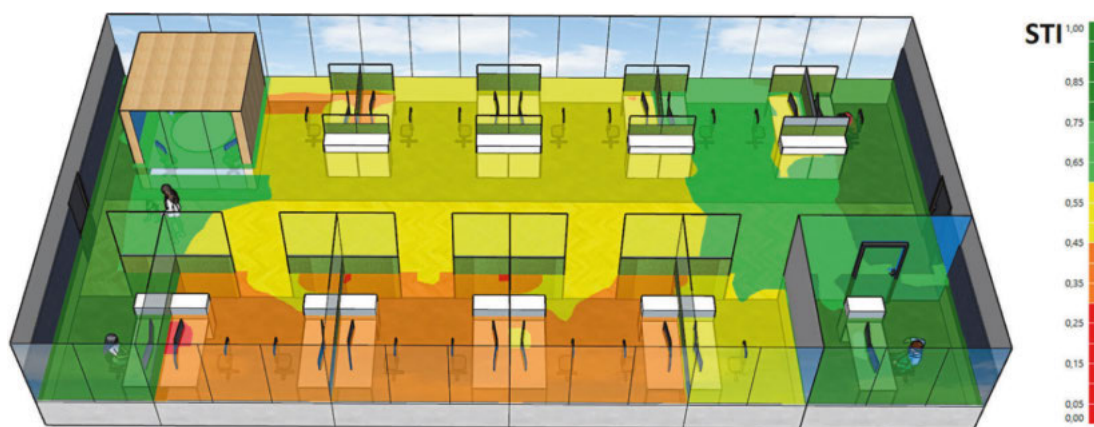
/ Variante 3: Sprachverständlichkeit; Grundgeräusch = 35 dB(A); vier gleichzeitige Sprecher:innen; STI sinkt bei geschirmten Arbeitsplätzen vor allem über weite und bei zonierten und abgetrennten Bereichen bereits über kurze Entfernungen.
